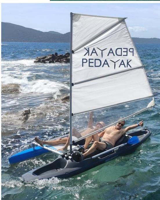
Dans l'esprit des pirogues à balancier polynésiennes qui traversaient le Pacifique, un flotteur stabilisateur est monté sur un côté du **PEDAYAK** avec une **structure** et un **trampoline**, la même que celle du **PEDAYAK TRIO**. Il vous offre un espace confortable pouvant recevoir jusqu'à 2 personnes supplémentaires, permettant bain de soleil à l'écart de la plage, plongeon, baignade, pique-nique, ou d'emporter du matériel de camping ou de plongée, etc.
